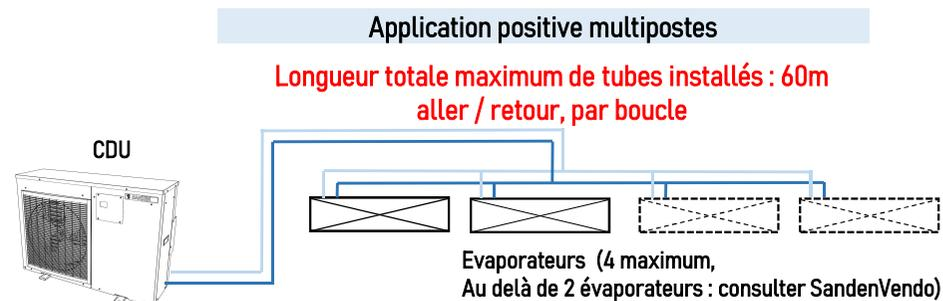
Une installation au-delà de ces distances entraîne un manque de performance ainsi qu'un mauvais retour d'huile au compresseur
